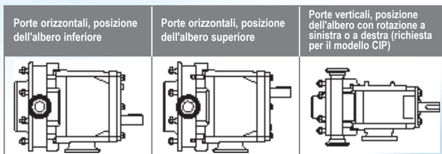
Il passo di montaggio deve essere mosso in una delle quattro posizioni per cambiare la connessione al motore e portare il trasferimento da orizzontale a verticale.
